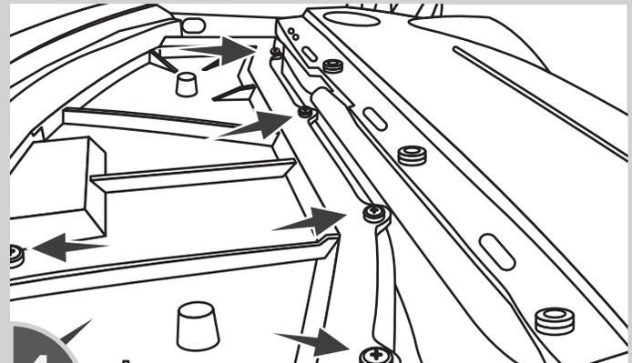
**4** REMOVER LOS SEIS TORNILLOS Y RETIRAR CUBIERTA
