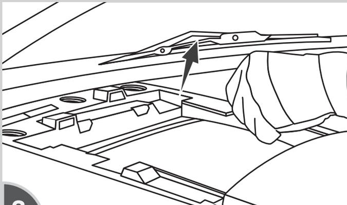
**3** HALAR Y RETIRAR CUBIERTA DEL LADO DERECHO DEL PANEL
