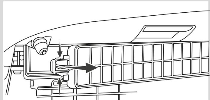
**4** RETIRAMOS LA TAPA PELLIZCANDO LAS PESTAÑAS SITUADAS EN EL LADO IZQUIERDO. / REMOVE THE COMPARTMENT LID BY PRESSING THE TABS SITUATED ON THE LEFT SIDE.
