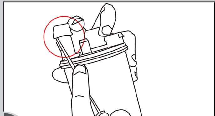
**10** RETIRAR LA TAPA DEL TUBO SUPERIOR DEL FILTRO CON AYUDA DE UN DESTORNILLADOR.
